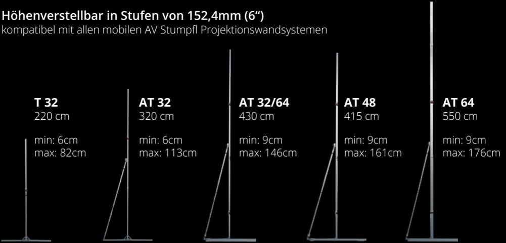
Für hohe Anforderungen an die Eigenstabilität, z.B. bei größeren Projektionswänden oder großer Aufstellhöhe, empfehlen wir die Verwendung von FüÙen der Baureihe: AT32 für MONOBLOX 32 sowie AT48 oder AT64 für MONOBLOX 64. AT-FüÙe haben eine ausziehbare Stütze, die mit zwei Flügel-schrauben festgeklemmt wird.
